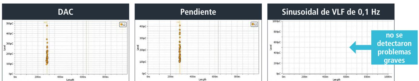
Asignación de descarga parcial para todas las tensiones de excitación (DAC, CR/pendiente de VLF y onda sinusoidal de VLF de 0,1 Hz) en la tensión nominal de  $U_0$ . El eje X es la longitud del cable, el eje Y es la altura de descarga.
