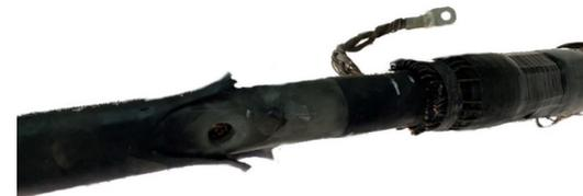
Figura 2. Perforación provocada por falla en cable XLPE 35 kV
