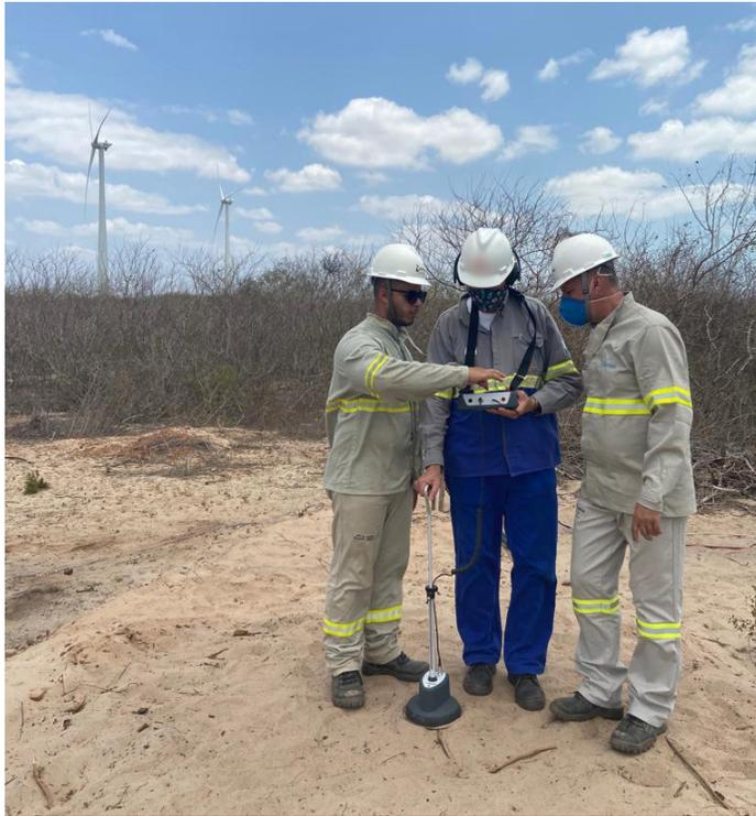
Figura 9. Localización Puntual Método acústico-magnético
