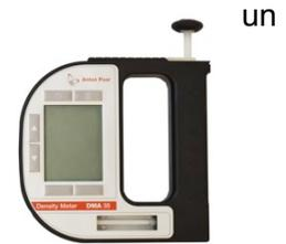
Esta prueba es aplicable solo a baterías inundadas, dado que se requiere acceder al electrolito para realizar la prueba. Esta prueba nos revelará el estado de carga (SOC, en inglés) de la batería, y también puede ayudar a identificar contaminantes en el electrolito. Esta prueba puede también ayudar a identificar la estratificación del electrolito.
