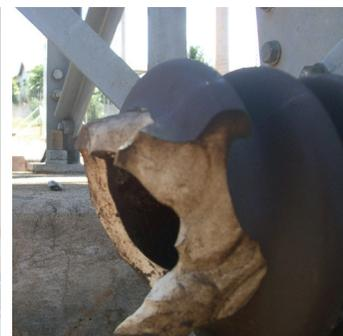
Un polo de un interruptor de circuito de distribución totalmente dañado por una explosión.
