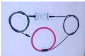
**RopeCT®** es un Transformador de Corriente flexible de gran exactitud, destinado a la medición de la circulación de corriente en grandes sistemas de baterías con secciones transversales grandes en los puentes de conexión
