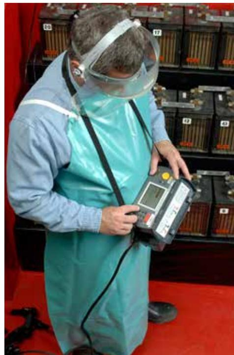
Prueba de baterías con **BITE3**
